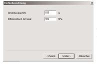
Ortshöhe und den Differenzdruck von Umgebungsdruck zum Kanal eingeben und Taste **Weiter** drükken.
